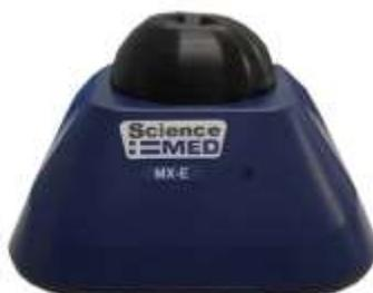
Agitador tipo vórtex con velocidad fija para agilizar los procedimientos en los que se necesite mezclar pequeñas cantidades de muestra. Tiene un diseño práctico por su tamaño pequeño. Ampliamente utilizado para varias aplicaciones de agitación o mezclado en las áreas de biotecnología, ingeniería genética y biología molecular.
