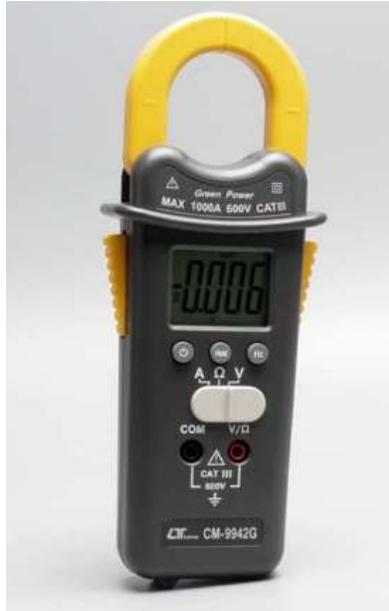
El Amperímetro de Gancho modelo LT-CM9942G con capacidad de 1000A/600V, No requiere Batería. Cuenta con su propio generador de energía integrado que le provee de energía verde. Acciona el generador de 10 a 20 segundos y te ofrecerá energía suficiente para medir continuamente por 10 minutos.
