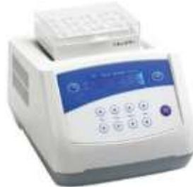
Diseñados para calentar, enfriar y mezclar pequeñas muestras en el laboratorio. La programación para la agitación, calentamiento o enfriamiento puede ser de manera simultánea o independiente. Permite utilizar bloques para diferentes capacidades.
