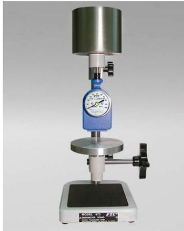
Este base de pruebas se puede utilizar con la línea de durómetros de estilo clásico o ergo de PTC. El Modelo 475 tiene un peso de 5kg y es para uso con los durómetros tipo C, D y DO de ASTM.
