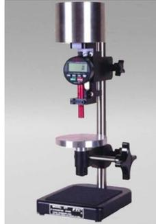
Este soporte es para usar con la línea de durómetros de estilo de lápiz de PTC® y también es totalmente compatible con durómetros de otra fabricación. El modelo 477 tiene un peso de 5 kilogramos y es para el uso con durómetros del tipo C, D y de la aguja de goteo de ASTM.
