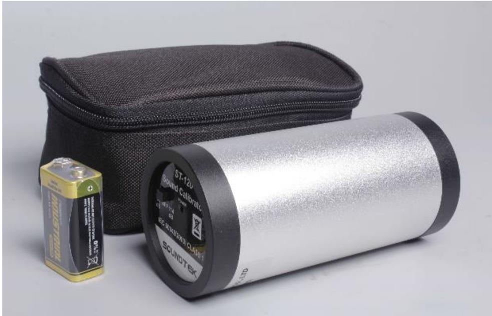
IEC 60942: 2003 clase 1 / ANSI S1.40-1984 Niveles de presión sonora: a 94dB y 114dB. Para la calibración del micrófono del condensador ½ Indicación de batería baja
