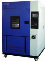
Esta serie de productos se utiliza principalmente para evaluar el rendimiento de resistencia al envejecimiento del ozono en el caucho y la eficacia protectora del agente anti ozono para tomar las medidas efectivas de resistencia al envejecimiento del ozono para extender la vida útil de los productos de caucho. Todo el proceso de generación y captura de ozono se realiza en un circuito hermético, lo que garantiza la seguridad de las personas.
