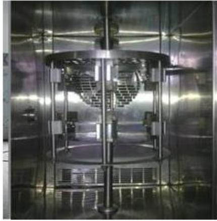
El interior del soporte de la muestra otras partes de accesorios, el interior del soporte de la muestra y accesorios tales como los catéteres son de acero inoxidable, al no ser afectados fácilmente por descomposición del ozono y los efectos de las concentraciones de ozono. El soporte de la muestra puede girar 360 grados, La velocidad puede ser ajustable.
