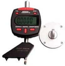
El medidor digital de profundidad para porosidades de soldadura modelo GG-13 es un instrumento que cuenta con varillas de extensión que le permiten medir profundidades desde 1" hasta 6".
