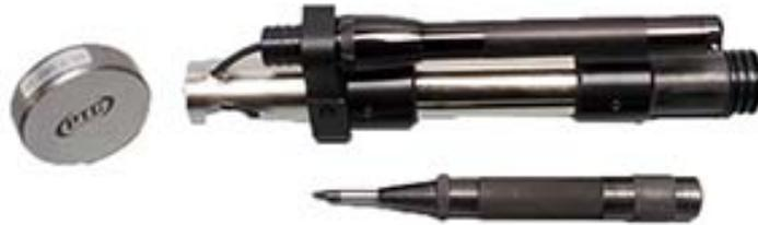
El durómetro Portátil HRC/Acero Mod.#316 es un probador de dureza para piezas de acero que mide la dureza directamente en escala Rockwell C.
