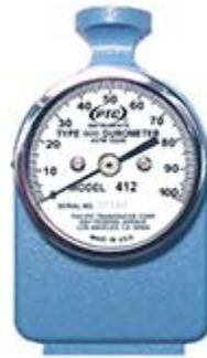
El durómetro de estilo clásico PTC® viene completo con bloque de prueba y estuche de transporte. Este instrumento está diseñado para ser portátil o con el modelo de peso muerto de prueba PTC 470.
