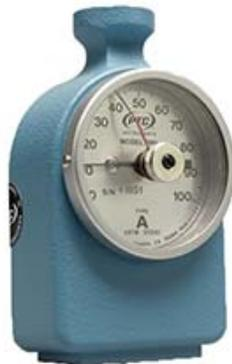
El modelo Durómetro PC-306L es un durómetro para plásticos, hules y compuestos de una gama de durezas que se conforman a los requisitos de la norma ASTM D2247. Existen modelos par diferentes escalas que van desde los plásticos más duros hasta las espumas más suaves . Construido con el estilo clásico de los medidores de dureza con una base amplia de 4” x 1” le otorga mucha estabilidad en la medición.
