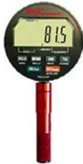
El durómetro DIGITAL modelo PC-212D es un durómetro especialmente diseñado para medir en superficies pequeñas ya que cuenta con una base de prueba con un diámetro de 1/2" (13mm) y una pantalla LED que despliega las mediciones en escala dureza Shore "D" de 0 a 100 puntos. El equipo otorga una precisión de +/-0.1 puntos.
