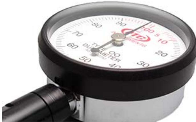
El durómetro PC-203 es un equipo con escala “ASTM OO” para medir la dureza de hules y esponjas muy suaves así como de materiales similares.
