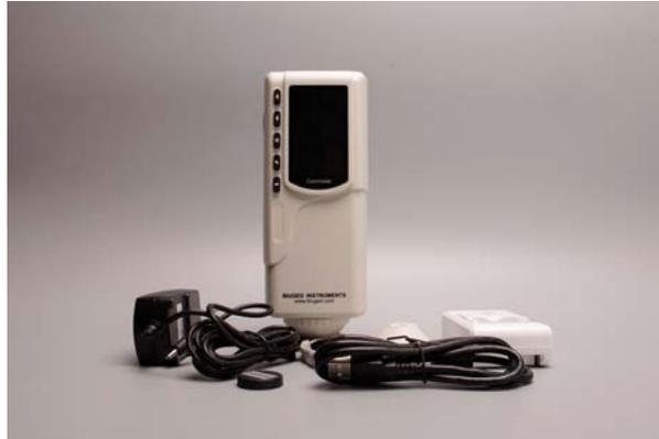
El Colorímetro de precisión BGD 551 es un equipo emblemático en pruebas de color para la industria. Incorpora los parámetros de placa blanca, no requiere calibrarse cada vez que realiza una medición rápida.
