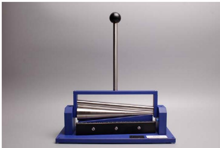
El Probador de Mandril Cónico BGD-566 es aplicable para determinar la extensibilidad de los revestimientos de pintura sobre paneles metálicos que están sujetos en su posición y formados alrededor del mandril cónico girando el marco del rodillo. Los paneles se examinan para evaluar la resistencia a la fisuración y el desprendimiento del sustrato metálico de la superficie revestida que está recubierta con pintura en condiciones estándar.
