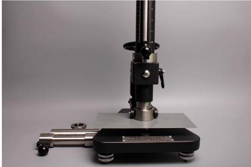
La prueba de impacto es un método de evaluación una películas secas de pintura, barniz o producto relacionado. La prueba determina la resistencia al agrietamiento o desprendimiento de la pintura en relación al sustrato tras sufrir una deformación causada por efecto de un impacto con un objeto que cae en un punto del sistema recubrimiento/sustrato. El impactómetro BL-BGD306 es el instrumento apropiado para este tipo de prueba.
