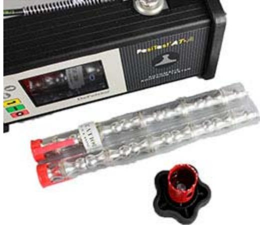
**El PosiTector DF-ATA es un probador Automático de adhesión de recubrimientos que por medio de un actuador hidráulico nos permite conocer la cantidad de fuerza requerida para desprender el recubrimiento de su sustrato.**
