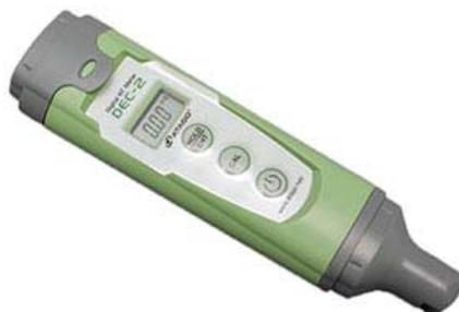
El DEC-2 es un económico medidor de electro conductividad. El diseño compacto y fácil de usar hace que el DEC-2 sea el instrumento ideal para llevar donde sea que se necesite medir conductividad. La unidad es resistente al agua (IP67). Además incluye Compensación de Temperatura Automática de 0 a 50°C.
