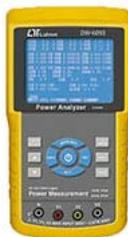
El analizador de calidad de energía DW6093 le permitirá cuantificar el consumo de energía en circuitos monofásicos, bifásicos y trifásicos. Con un arreglo de 3 sondas de corriente tipo pinza (efecto hall) y cuatro cables de prueba con sujetador tipo caimán podrá configurar una variedad de pruebas que incluyen True RMS en voltaje y corriente en 1 fase con 2 hilos, 1 fase con 3 hilos, 2 fases con 3 hilos y 3 fases con 4 hilos.
