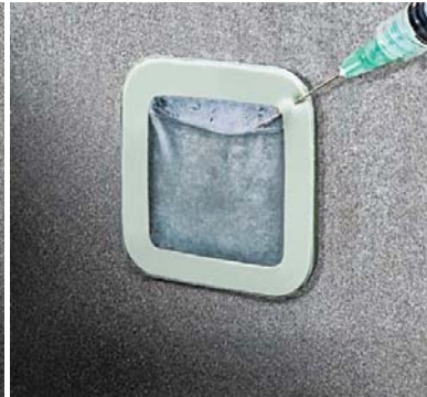
Parche Adhesivo DeFelsko
