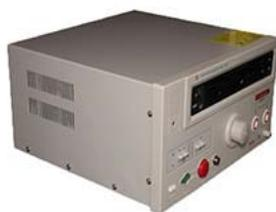
Medición de precisión con ajuste continuo de corriente de fuga y tiempo de prueba en alto voltaje con baja corriente.
