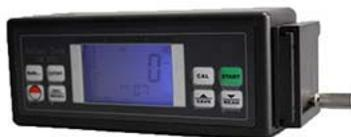
El rugosímetro portátil modelo GR270BT es el equipo adecuado para uso directamente en la línea de producción y puede utilizarse para medir la rugosidad superficial de una variedad de piezas maquinadas, calcula distintos parámetros de rugosidad conforme a las configuraciones de medición seleccionadas.
