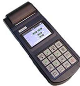
El probador de vibraciones portátil utiliza un transductor de aceleración piezoeléctrico para convertir la señal de vibración en señal eléctrica. Luego, al analizar la señal de entrada, se muestran o imprimen los resultados que incluyen el RMS de los valores de velocidad, el valor pico de pico de desplazamiento, los valores máximos de aceleración o los gráficos espectrales en tiempo real.
