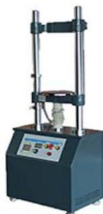
El soporte de prueba vertical / horizontal eléctrico de la serie SJX es una medición de tracción / compresión especialmente diseñada para coincidir con el medidor de fuerza de empuje.
