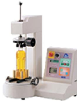
Banco de pruebas vertical motorizado IM-MX1100 le permitirá estabilizar sus pruebas y cumplir con mediciones sencillas de tensión y compresión. Entre las principales características de este tipo de soportes se encuentran el control de velocidad ajustable, control de fuerza, retorno rápido y paro de emergencia.
