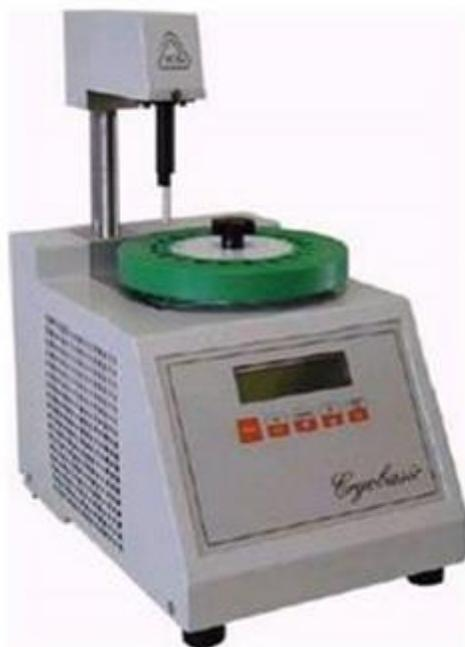
con carrusel automático para 20 muestras. El punto crioscópico y el porcentaje de agua adicionada aparecen en la pantalla de LCD
