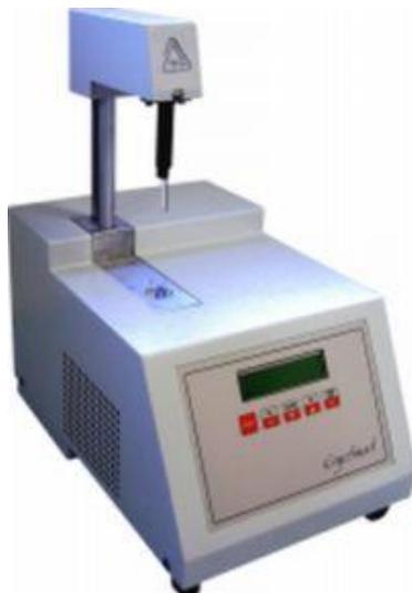
Es un crioscopio automático para la rápida y exacta determinación de la variación del punto de congelación de la leche y del porcentaje de agua adicionada, según las normas internacionales FIL-IDF-ISO 5764:2002 y AFNOR.
