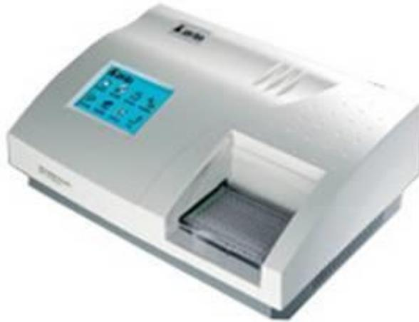
Operado por microprocesador, el sistema fotométrico está diseñado para leer y calcular el resultado de los análisis incluyendo tumores y marcas contagiosos, el Display es táctil para facilitar la operación, tiene 100 pruebas programadas. Varios tipos de modo de calculo :Absorbancia
