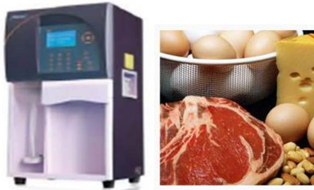
Microdestilador Kjeldahl semi-automático operado por microprocesador. Rango de 0.1 a 240 mg de Nitrógeno, exactitud de 0.5%, velocidad de destilación: 5 minutos, consumo de agua de enfriamiento: 1.5 litros / minuto. Operación manual o automática para la adición de la solución alcali, ácido bórico y agua destilada, mide 40x36x75 cm. de altura. Opera con 220 volts. Usa el método estándar internacional Kjeldahl: por digestión con ácido sulfúrico, destilación con alcali, absorción de ácido bórico.
