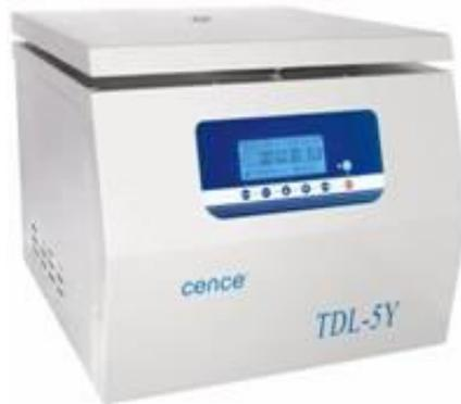
Centrífuga para combustibles líquidos y/o agua, de acuerdo con el Método ASTM D1796-04 Standard Test Method for Water and Sediment in Fuel Oils by the Centrifuge Method (Laboratory Procedure) con pantalla LCD, velocidad máxima 4000 r.p.m.
