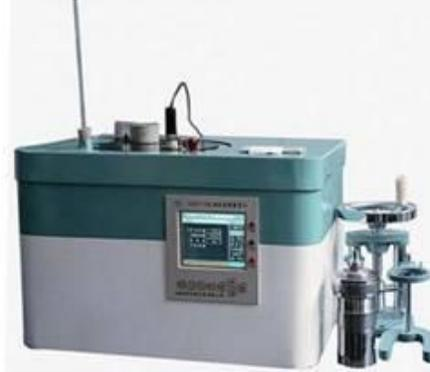
**Controlado por microprocesador**, Para la determinación automática del valor calorífico de muestras sólidas y líquidas, como el carbón, coque, petróleo y alcohol. Por lo general se usa en las minas de carbón, plantas de motores, fábricas de cemento, fábricas de vidrio, productos farmacéuticos, productos alimenticios, Universidades y Centros de Investigación, cumple con el método ASTM D240.
