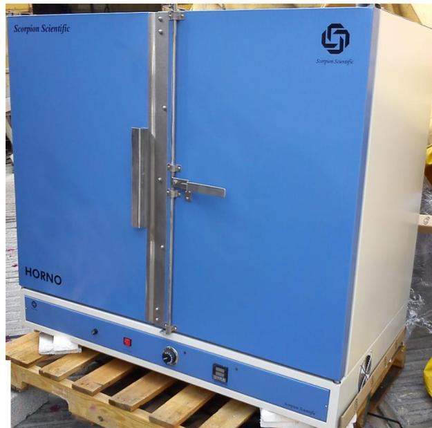
Con doble control de temperatura (uno digital otro hidráulico de seguridad) desde ambiente hasta 220° C con sensibilidad de +1° C a 100° C, interior de acero inoxidable de 100 x 60 x 70 cm., convección mecánica (aire forzado), se incluyen 4 entrepaños, Interfaz RS232 y Software. Opera con 120 volts. **Fab. Nal.**
