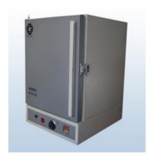
De convección mecánica (aire forzado), con doble control de temperatura (uno digital, otro hidráulico de seguridad) desde ambiente hasta 250°C con sensibilidad de +- 1°C a 100°C. Interior de acero inoxidable de 35x35x35 cm (Capacidad 42 Litros). Se incluyen 2 entrepaños. Opera con 120 volts, **Fab. Nal.**
