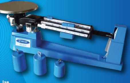
Balanza granataria manual de 3 brazos, abarca las necesidades generales en el trabajo de laboratorios escolares de física y química, facilita las pesadas continuas. Está fabricada con una aleación rígida de aluminio de alta calidad, para mayor durabilidad. Fácilmente ajustable a ceros, cuenta con barras graduadas al centro de 10 g (0.1g), 100 g (10g) y 500 g (100g). Su plato de pesaje es de acero inoxidable e incluye pesas para alcanzar una capacidad máxima de 2610 g.
