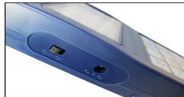
El Vibrómetro GL-GV300 usa un transductor de aceleración piezoeléctrico para captar una señal de una fuente de vibración y convertirla en un valor de entrada. Entonces, analizando este valor de entrada, se pueden visualizar en pantalla o imprimir en papel los valores de los siguientes parámetros:
