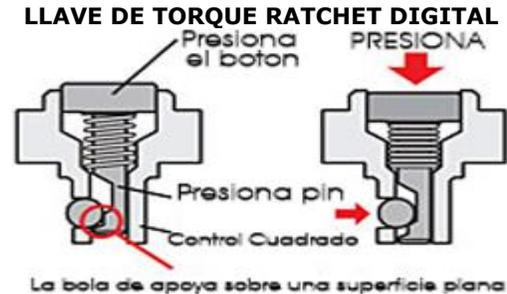
La bola en el cuadro de accionamiento descansa sobre una plataforma pequeña de la chincheta y no puede ser empujada sin presionar la chincheta, con ningún desprendimiento accidental.
