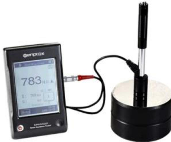
PO-EPX5500 Durómetro por método Leeb PO-EXP5500 probador de dureza ligero y portátil, conveniente para hacer pruebas en partes pesadas, grandes o exteriores metálicas que no se puedan transportar a laboratorio. Capaz de medir en cualquier dirección; fácil de usar y gran precisión al hacer pruebas sobre algunas superficies curvas. El durómetro PO-EPX5500 puede compensar automáticamente el efecto gravitacional
