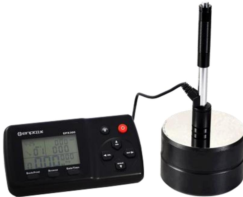
Es un probador de dureza ligero, portátil y conveniente para hacer pruebas en partes metálicas pesadas, grandes ubicadas en exteriores o directamente en el sitio de construcción. Se adapta a Estándar ASTM A956-02 & DIN 50156.
