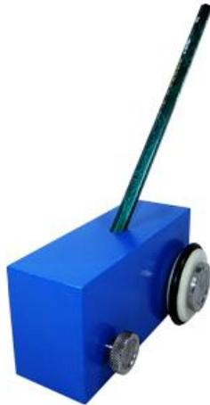
En la prueba de Wolff-Wilborn, los lápices de varios grados de dureza se mueven rayando la superficie bajo una presión y ángulos fijos con respecto a la superficie. El grado de dureza del lápiz que dañe la pintura de la superficie recubierta se toma como medida de la dureza al rasguño. Ejemplo: Dureza "3H".
