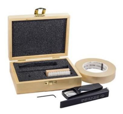
Este es un kit para la medición de adherencia sobre superficies metálicas.
