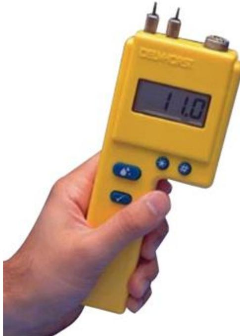
El nuevo y rediseño PA-2000 es un medidor de humedad eléctrico de tipo de resistencia, utilizando la relación entre el contenido de humedad y resistencia eléctrica. Los pins de contacto montados en la parte superior del medidor son usados para hacer un contacto directo con el material.
