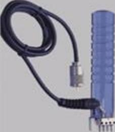
A blue probe with two rows of pins and a black cable. The pins are used for measuring moisture content in samples of varying thickness.   | <p>15-E</p> <p>De tipo pins, con dos filas de pins cada uno, máxima penetración 1/8". La penetración puede ajustarse de acuerdo al espesor de la muestra.</p>  |
