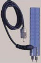
A blue rectangular probe with a black cable and a connector. The probe has two sharp pins at the bottom.                                    | <p>2-E</p> <p>Tipo pins, máxima penetración 5/16". Usados en superficies curvas como cartulina y tubos de papel especialmente si es de diámetro pequeño.</p>   |
