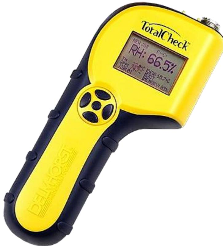
Altos niveles de humedad ambiental pueden ser señal de ADVERTENCIA en trabajos de inspección y RH, también es motivo de preocupación cuando se instala un piso de concreto en planta alta. Para abordar esta preocupación, el TotalCheck fue diseñado para ajustarse a la norma ASTM F2170 para determinar el RH en una losa de hormigón, utilizando sondas para trabajo de campo.
