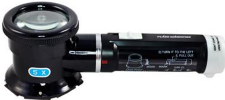
Instrumento de campo, diseñado para determinar rápida y eficazmente, el perfil de anclaje en las superficies con acabado superficial en base a chorro de arena (sand-blast).
