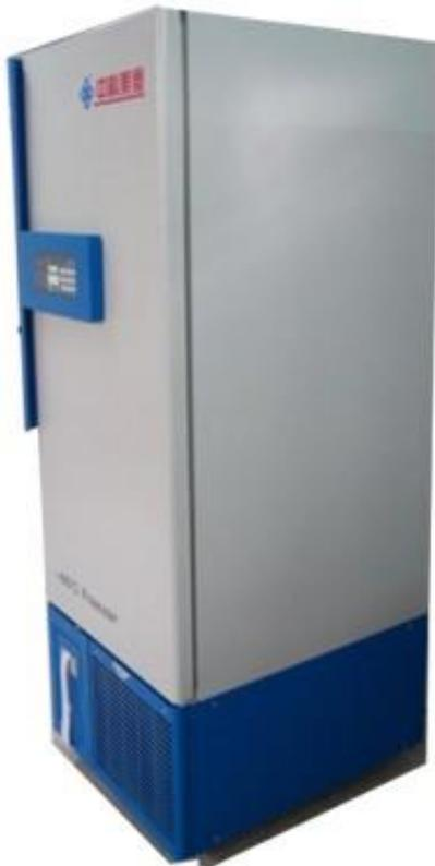
**DW/HL538 Ultracongelador Vertical con control digital desde -10 hasta -86°C. Ultracongelador vertical, capacidad de 540 litros (20 pies cúbicos)** con interiores de acero inoxidable, con 4 compartimentos, puerta exterior de acero esmaltado con doble sello. Con control digital desde -10 hasta -86°C. Con aislamiento de 150 mm de espesor.
