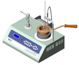
SYP1001B-V P-1002 Aparato manual para determinar el punto de inflamación con la copa abierta de Cleveland, a través del método GB/T3536 ASTM D92 Flash-Point etc. Control de temperatura auto programable, ignición a control remoto, pantalla digital.
