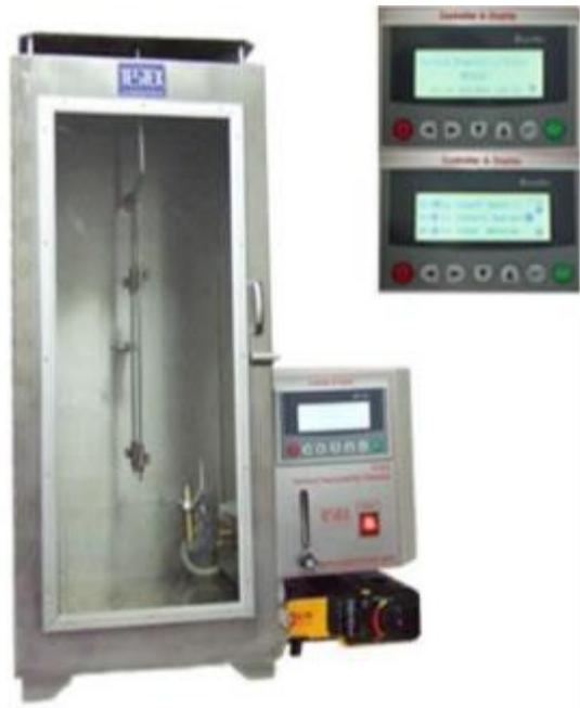
**TF312 Aparato para probar la resistencia a la FLAMABILIDAD,VERTICAL,** construido DE ACERO INOXIDABLE PARA MEDIR LA VELOCIDAD DE QUEMADO DE TEXTILES. Cámara de flamabilidad vertical para medir la propagación vertical de la llama de tejidos y otros materiales textiles o materiales de relleno elástico utilizado en muebles tapizados de acuerdo con la **Norma ASTM D6413.**
