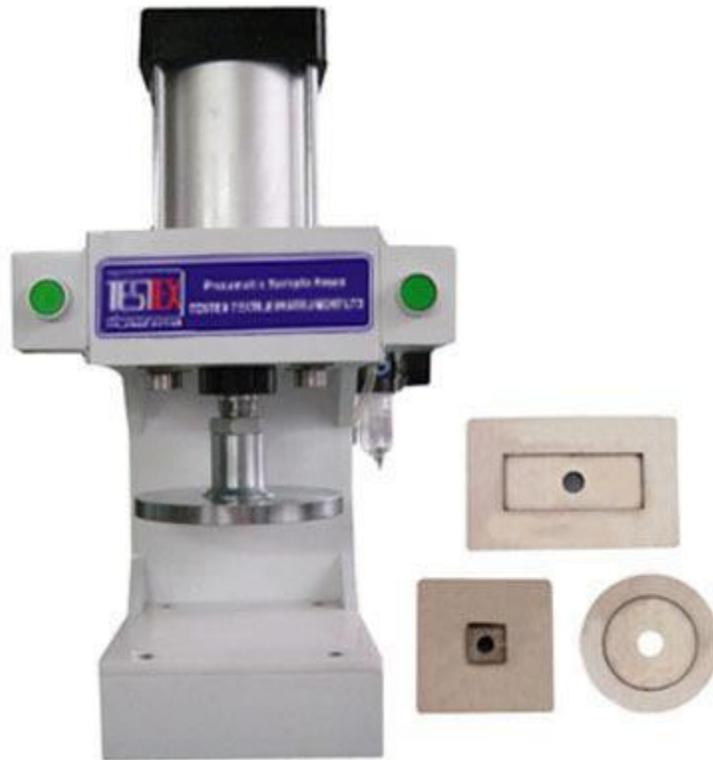
**Cortador Neumático**, un nuevo tipo de escritorio presionen muestra, para cortar muestras para las pruebas u otro uso. Equipada con cilindro de 125 mm, profundidad de corte de 10 mm y mesa de 125 x 125mm.. Bajo la presión de 1100 psi puede producir 500-800kg / f presión, equipado con una operación de enlace de seguridad doble. Puede configurarse para hacer un corte especial. Se requiere aire comprimido.
