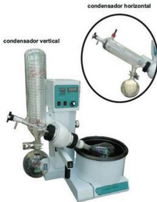
Este equipo se utiliza para hacer destilaciones al vacío y con movimiento giratorio; esto permite que se genere una película del solvente que evapora fácilmente sin que se tengan que utilizar altas temperaturas para que el producto no se degrade.
