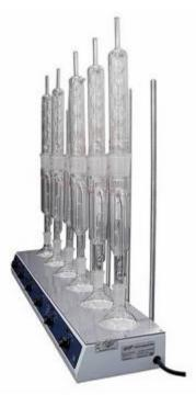
Manta de calentamiento múltiple. Esta manta sirve para calentar matraces esféricos de forma delicada y uniforme, se puede utilizar para el extractor soxhelt, para hacer reflujos, destilaciones, etc.
