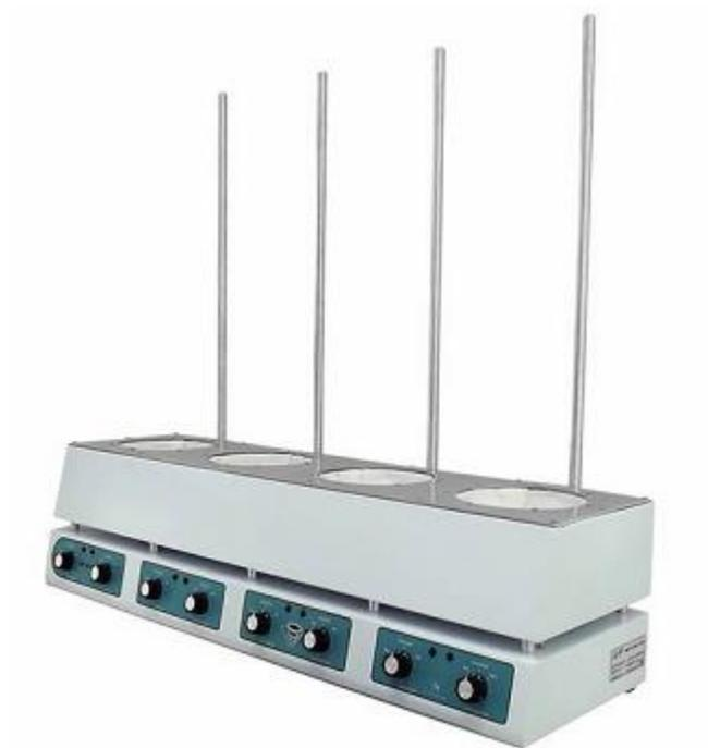
Manta de calentamiento con control de temperatura integrado y agitación. Ésta manta sirve para calentar matraces esféricos de forma delicada y uniforme, se puede utilizar para el extractor soxhelt, para hacer reflujos, destilaciones, etc.
